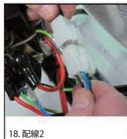
18. 配線2 (コイル、CDIモジュール、ピックアップセンサーケーブル)の白カバーにCDIモジュールのカプラーを接続する。
