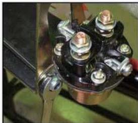
11. リレーをバッテリーホルダーにしっかりと固定する。6mmナットを取付けしっかりと締めこむ。
