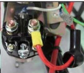
13. 配線1を黒いカバーの赤線をリレーの右の8mmターミナル上部に取付ける。締め込んだ後に黒いカバーをターミナルに被せる。
