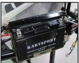
16. バッテリーとバッテリーホルダープレートとバッテリーホルダーに取付ける。6mmボルト2本でしっかりと固定する。
