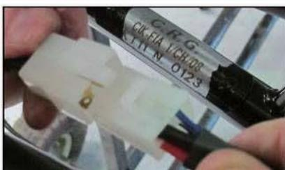
23. 配線3の4ピンプラグを配線4 (スターター、エンジンケーブル)の4ピンプラグに接続する。
