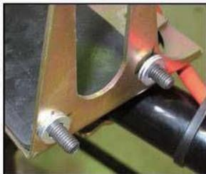
10. ボタンキャップボルトをバッテリーホルダーの内側から外側に向けて取付ける。ワッシャーは外輪に2枚ずつ取付ける。
