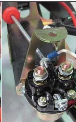
12. 配線1 (スイッチ、バッテリー、リレーケーブル)を白ワイヤーのリングをリレーの後方に取付けヘキサゴンキャップボルトで締める。
